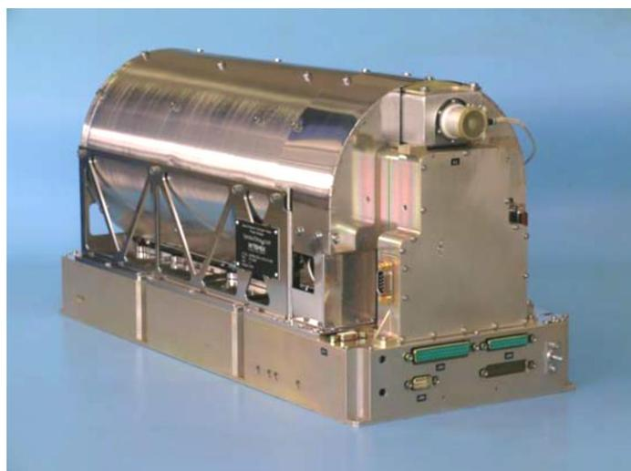
*Horloge à hydrogène*
